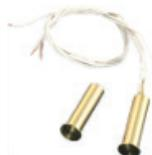
Contatto magnetico in ottone forma cilindrica installazione ad incasso a scomparsa. Adatto anche ad infissi in alluminio. Campo magnetico 10mm. Corrente massima di transito 500mA a 30V. Dimensioni L26XD6 testa D8
