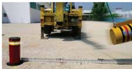
Inoltre prima della sua commercializzazione, ogni dissuasore viene testato per un'intera giornata simulando situazioni reali con cicli completi ed intensivi di apertura e chiusura.
