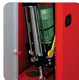
Motore elettrico, centralina oleodinamica e pistone compatti in un unico gruppo
